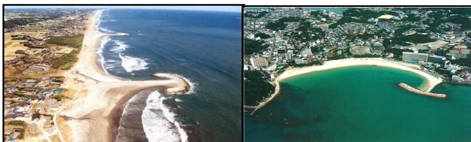
(ซ้าย) หัวแหลมหรือหัวหาดร่วมกับการถมทรายเสริมชายหาด และเขื่อนป้องกันคลื่นนอกชายฝั่งแบบจอมน้ำ เพื่อสงวนรักษาชายหาดชิราฮามา จังหวัดวากายามา ญี่ปุ่น และ (ขวา) หัวแหลมร่วมกับการถมทรายเสริมชายหาดเพื่อฟื้นฟูชายหาดในญี่ปุ่น (สนับสนุนภาพจาก ดร. มานะ ภัทรพานิชกรรมการผู้จัดการบริษัท ชีสเปคตรัม จำกัด)
