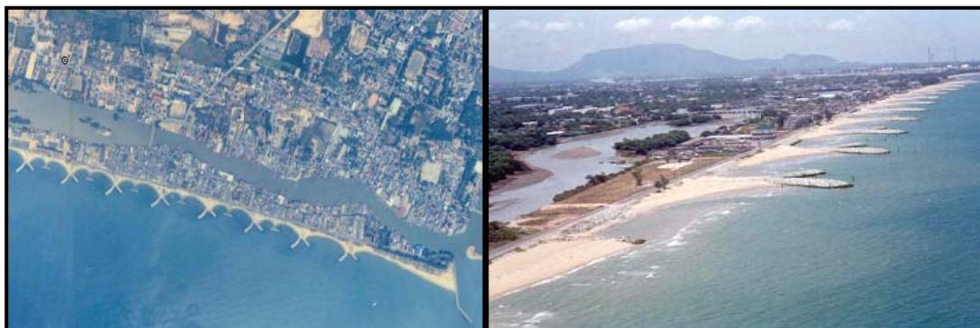
(ซ้าย) รอดักทรายแบบทางปลาสร้างควบคู่กับเขื่อนป้องกันคลื่นนอกชายฝั่งบริเวณหาดแสงจันทร์ จังหวัดระยอง (ขวา) รอดักทรายแบบทางปลาบริเวณแหลมเจริญ จังหวัดระยอง (สนับสนุนภาพจาก ดร. มานะ ภัทรพานิช กรรมการผู้จัดการบริษัท ซีเอสเปคตรัมจำกัด)
