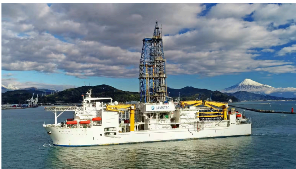
เรือสำรวจ Chikyu ที่มีการปล่อยท่อลงไปใต้ผิวน้ำทะเลลึก 5,500 เมตร เพื่อสกัดแร่ธาตุหายาก (ที่มา: https://asia.nikkei.com/spotlight/supply-chain/japan-to-begin-extracting-deep-sea-rare-earths-next-year )
