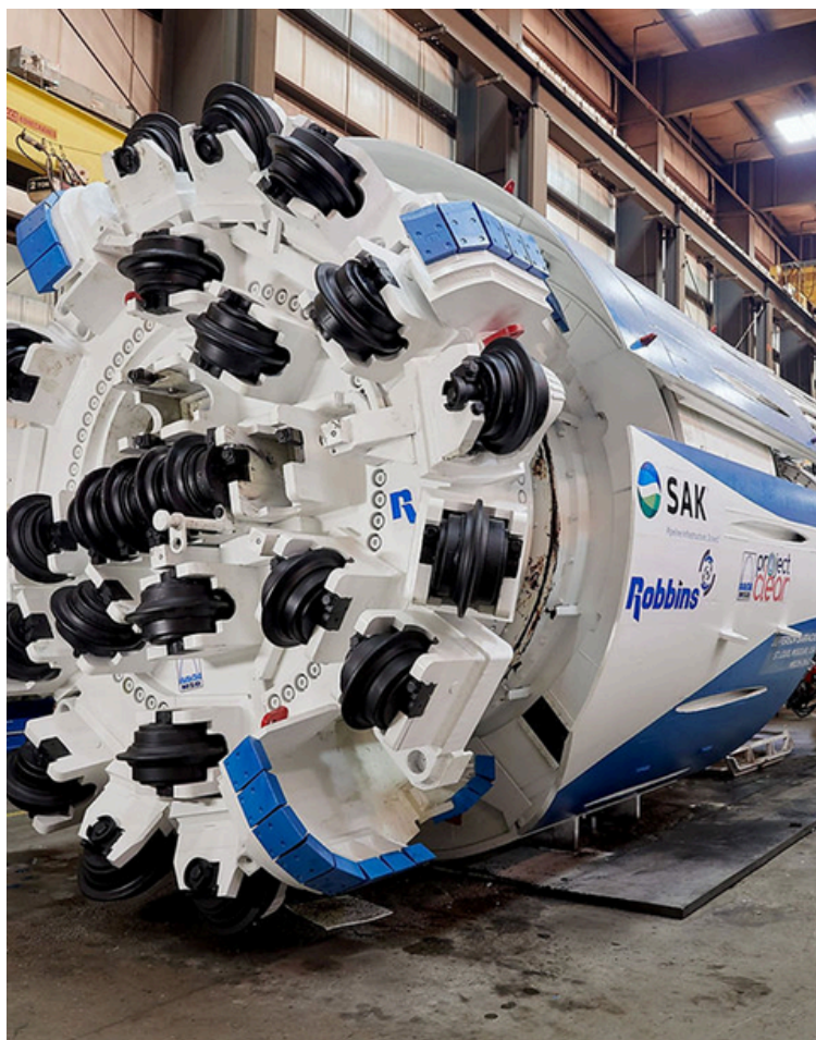
เครื่องเจาะอุโมงค์ในโครงการ Lower meramec tunnel phase 2 (ที่มา: www.affholder.com/projects/lower-meramec-tunnel-phase-2 )
