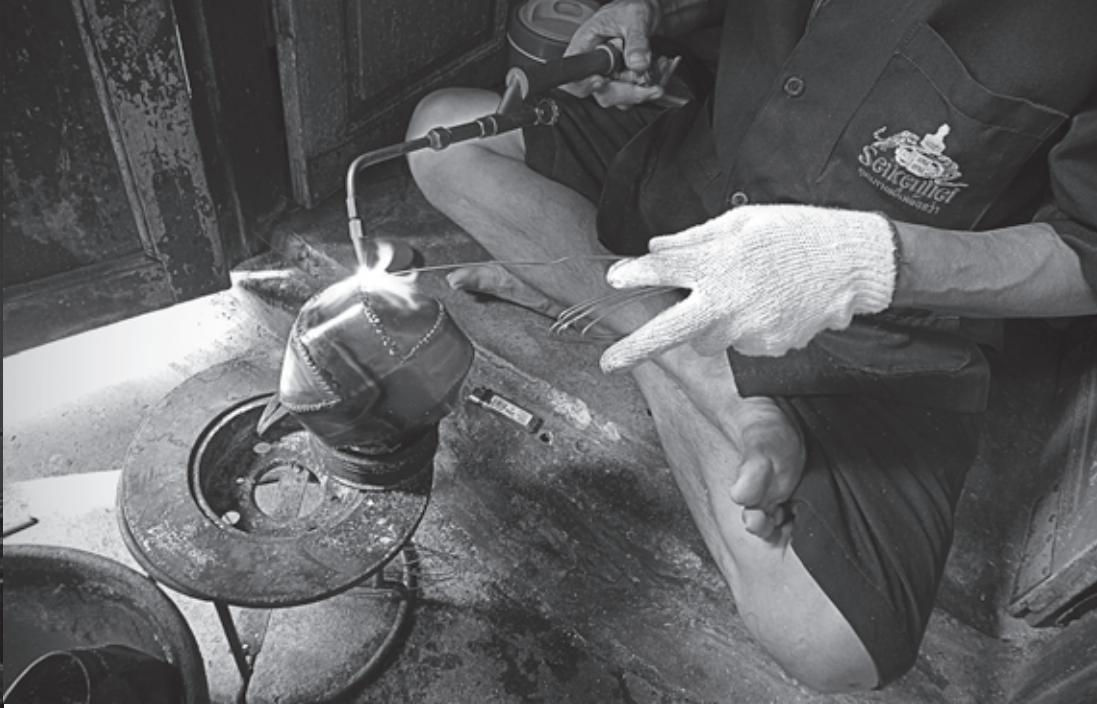
**ขั้นตอนที่ ๒ การประกอบกง** ช่างจะตัดแผ่นเหล็กเป็นรูปภาคบาท ซึ่งเรียกว่า ‘กง’ จากนั้นจึงดัดงอขึ้นรูปแล้วนำมาติดกับขอบบานตร เมื่อขึ้นรูปเสร็จจะเหลือซ่องว่างรูปสามเหลี่ยมใบโพ ๔ ช่อง ช่างจะวัดและตัดแผ่นเหล็ก รูปร่างเหมือนใบหน้าวัว ๔ ชิ้น ที่เรียกว่า ‘หน้าวัว’ หรือ ‘กลีบบัว’ จักฟันโดยรอบเพื่อใช้เป็นตะเข็บเชื่อมกับส่วนต่าง ๆ ตีให้หงอเล็กน้อยตามรูปทรงของบานตร ซึ่งเมื่อประกอบกันแล้ว จะได้บานตรที่มีตะเข็บ ๘ ชิ้นพอดี
