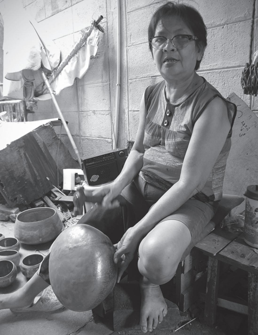
**ขั้นตอนที่ ๕ การตี** ซ่างจะใช้ค้อนเหล็กตีผิวด้านนอกของบานตรให้รอบเพื่อให้ส่วนที่ญูนออกมายกกระถาง เรียบเสมอ กัน รวมทั้งตีให้รอยตะเข็บที่ยังชรุขระเรียบเสมอ กัน จากนั้นต้องนำไป ‘ตีลาย’ บนทั่งไม้ เพื่อให้ได้รูปทรงตามต้องการ แล้วนำไปเจียร์ต่อโดยใช้เครื่องเจียไฟฟ้า แล้วจึงนำไปตกแต่งให้สวยงามอีกครั้ง ซึ่งจะได้บานตรสีเงินขึ้นเงาเวววับ
