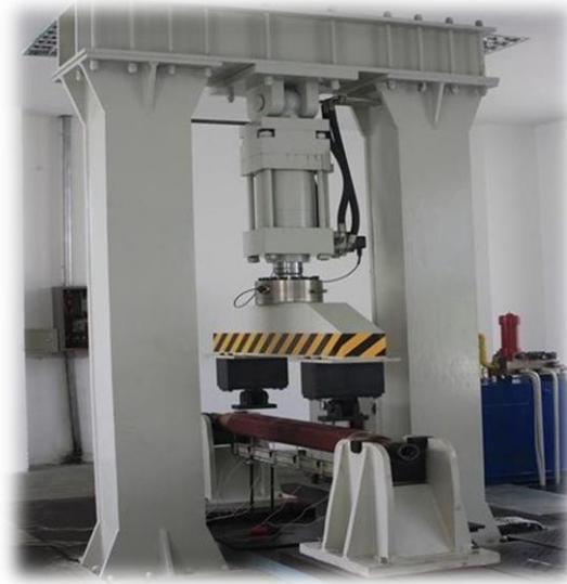
เครื่องทดสอบหมอนรถไฟและสปริง ทดสอบรอยร้าวรางรถไฟ
