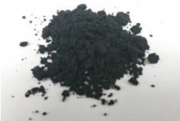
▲ ลักษณะภายนอกของ Cotalyst BP เป็นสีดำที่มีความชื้นและสามารถกระจายตัวได้ดีในน้ำ
