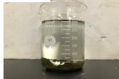
▲ ไม่เพียงแต่สลาย COD และ TOC เท่านั้นแต่ยังรวมถึงโลหะเจือปนด้วย หลังการบำบัดด้วยโอโซนของแคว้นน้ำใสบนบนจะไม่มีสีและโปร่งใส
