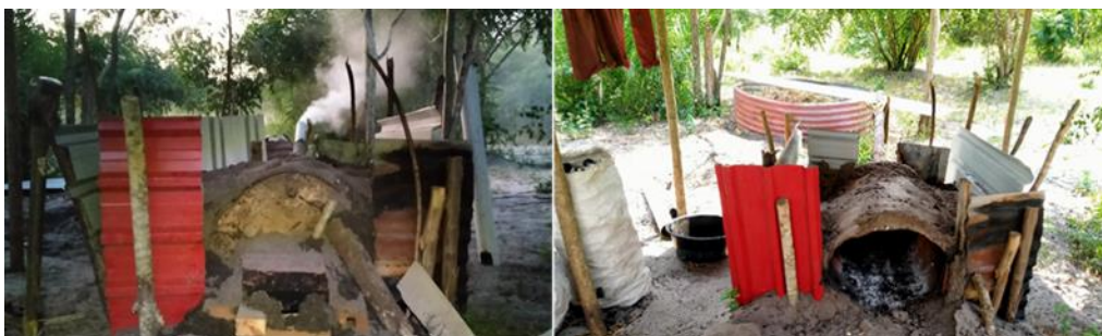
ภาพที่ 12 ทดลองเผาถ่านจากถังเหล็ก 200 ลิตร เพื่อเก็บน้ำส้มควันไม้
