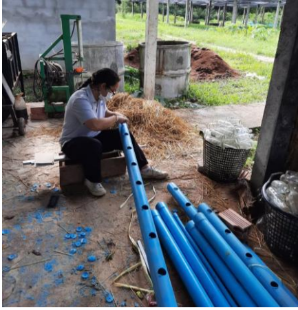
รูปที่ 7 ร่วมทำโต๊ะปลูกผักแบบไฮโดรโปนิคส์
